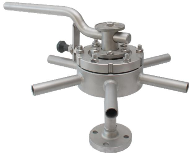
**Konstruktionsmerkmale** Der Senkrechte Abgang nach unten dient dem Medienein- oder -austritt. Verbindung besteht jeweils nur mit einem der waagrechten 4 - 6 Abgänge. Die Armatur kann wahlweise mit oder ohne positive Überdeckung gefertigt werden (positive Überdeckung = Überschneidungsfrei beim Umschalten). Betätigung erfolgt manuell über Handhebel oder Getriebe bzw. automatisiert wahlweise elektrisch oder mit Pneumatikantrieb + AZ-Schrittschaltkupplung.
